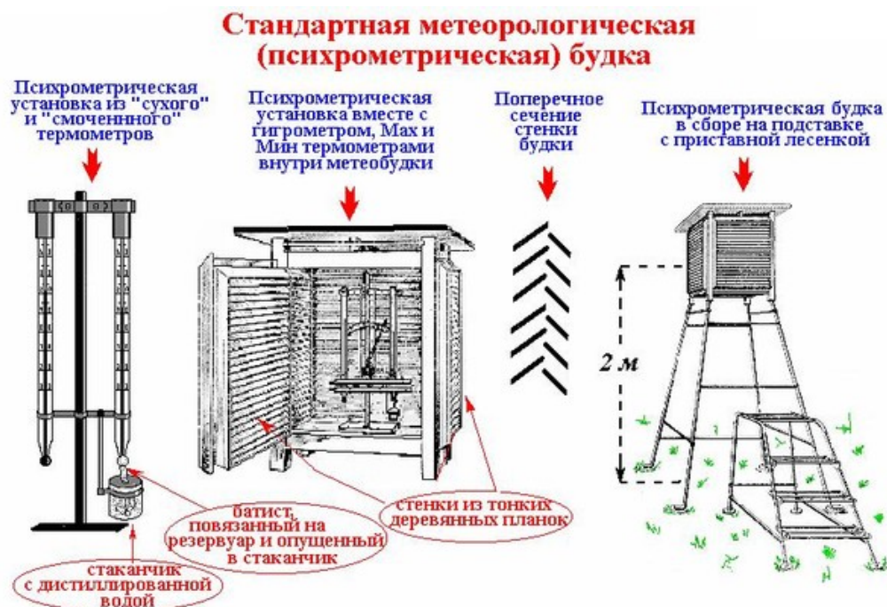
Рис. 3. Психрометрическая будка (общий вид)
