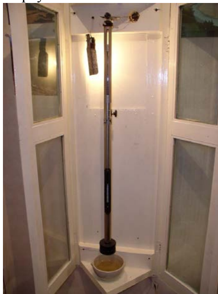
Рис.6. Чашечный ртутный барометр
